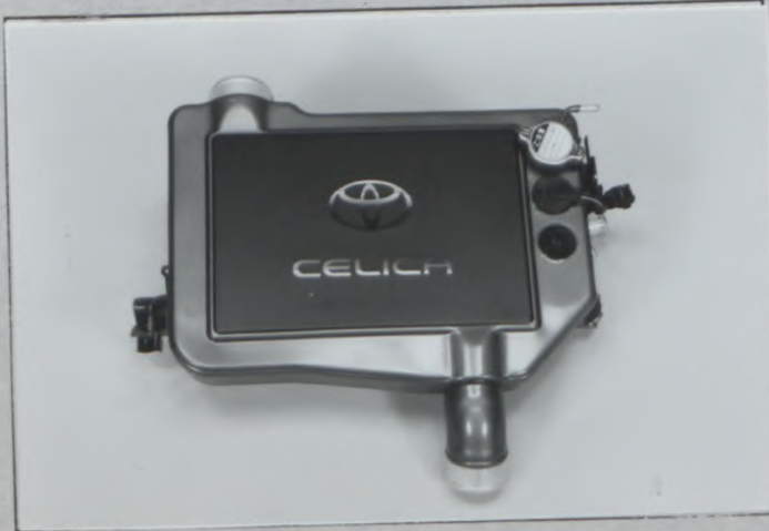
R) Echangeur intermédiaire déposé Intercooler dismounted
