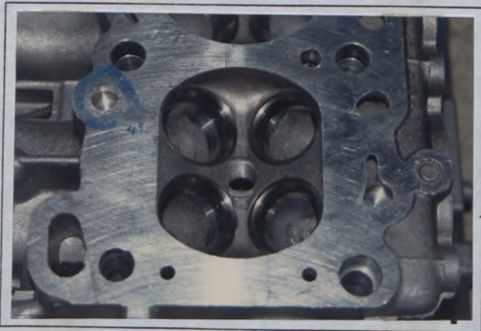
G) Chambre de combustion Combustion chamber
