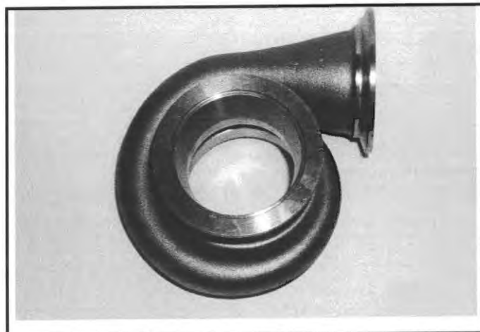
N) Carter de turbine du turbocompresseur Turbine housing of turbocharger
