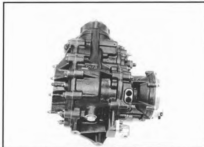
DI3-4) Carter du différentiel (vue 2) Differential housing (view 2) :
