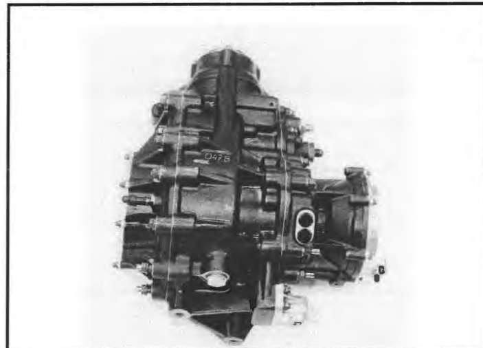
DI3-4) Carter du différentiel (vue 2) Differential housing (view 2) :
