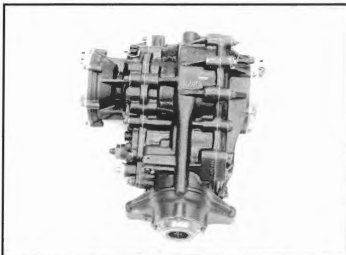
DI3-3) Carter du différentiel (vue 1) Differential housing (view 1) :
