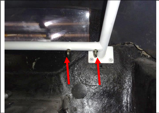
PHOTO 12 FIXATION DES SANGLES D'ÉPAULES – PILOTE OPTION : SANS INSERTS
