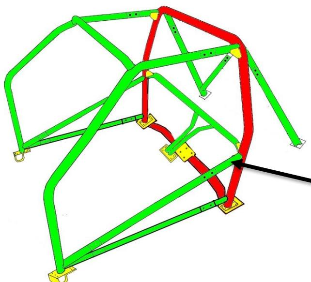
**DESSIN AVEC NUMEROTATION DE LA STRUCTURE DE L'ARMATURE DE SECURITE
